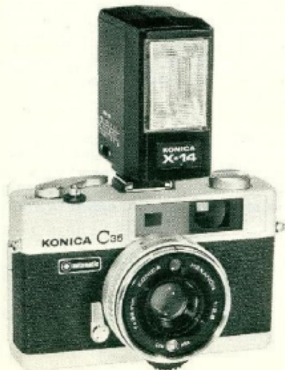
Bei Verwendung eines X-14 Blitzgerätes steckt man dieses in den Zubehörklemme der Kamera, die Kamera wird automatisch von AUTO-Stellung auf Blitzphotographie umgestellt, insofern Sie die Leitzahl 14 einstellen (d.h. wenn ein Film mit einer Empfindlichkeit von 20 bis 22 DIN verwendet wird). Die richtige Blendeneinstellung erfolgt hierbei automatisch je nach der Einstellung der Brennweite.
