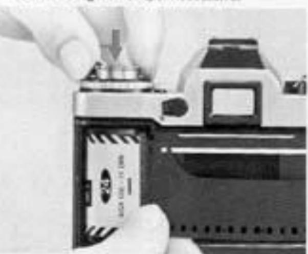
2. En laissant le bouton dans cette position, mettre en place une cartouche dans son logement, la tête de l'axe vers le bas de l'appareil. Puis, repousser à fond le bouton de déverrouillage vers l'intérieur, en le tournant légèrement, si nécessaire.
