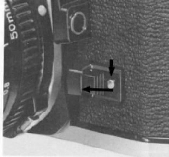
possible de fermer le diaphragme qu'à l'ouverture utilisée pour la photo précédente. D'autre part, il est impossible d'enfoncer le poussoir de fermeture du diaphragme quand la bague du diaphragme est sur «A». Il est à noter que la mesure à diaphragme fermé n'est pas possible avec le AE-1 équipé d'un objectif FD.
