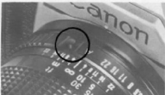
**1. Régler la bague du diaphragme sur le repère «A».**
