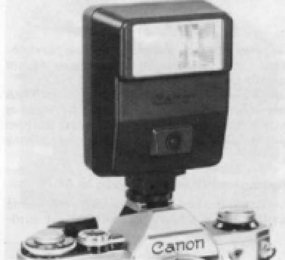
la bague du diaphragme sur l'ouverture nécessaire en fonction de la sensibilité du film. Dans les deux cas, la vitesse d'obturation passe automatiquement sur le 1/60 seconde, qui est la vitesse de synchronisation.
