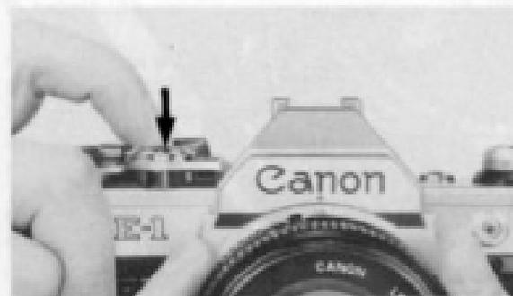
**6. Armer l'obturateur, vérifier l'ouverture et actionner le déclencheur.**
