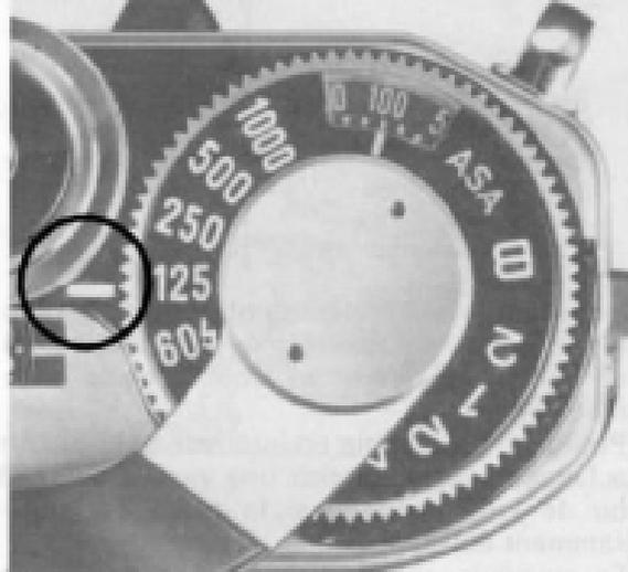
Pour régler la vitesse d'obturation, tourner le sélecteur dans un sens ou dans l'autre jusqu'à placer le chiffre voulu en regard du repère blanc. Il ne faut pas placer le sélecteur sur une position intermédiaire, et on se rappellera qu'il est impossible de passer directement de la position 1000 à la position «B».
