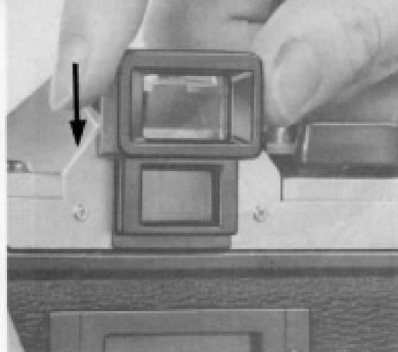
Il est possible de monter sur l'oculaire du viseur des accessoires tels qu'un œillette, une lentille de correction dioptrique, un viseur d'angle ou une loupe de mise au point.
