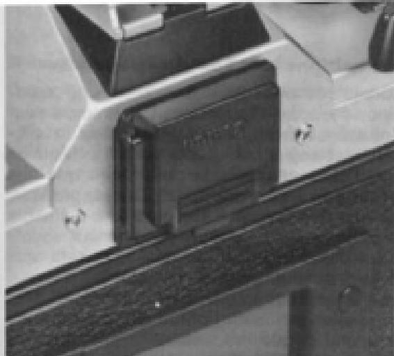
D'autre part, pour éviter que des rayons parasites entrant par l'oculaire du viseur ne faussent la mesure du posemètre, il est conseillé de couvrir l'oculaire de la main au moment d'appuyer sur le déclencheur. On peut aussi monter sur l'oculaire l'obturateur qui se trouve normalement dans la griffe porte-accessoire.
