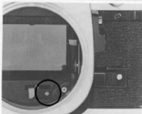
Lorsqu'un objectif de la série FD est monté sur le AE-1, la mesure doit toujours se faire à pleine ouverture. La mesure à diaphragme fermé donnerait des résultats erronés. Seule exception à cette règle: quand un accessoire non couplé est placé entre l'objectif et le boîtier.
