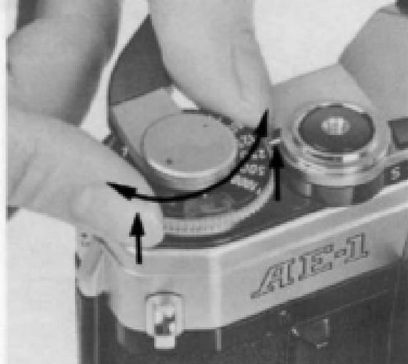
Le posemètre de l'appareil peut être réglé sur les valeurs ASA suivantes, les chiffres entre parenthèses indiquant les sensibilités intermédiaires:
